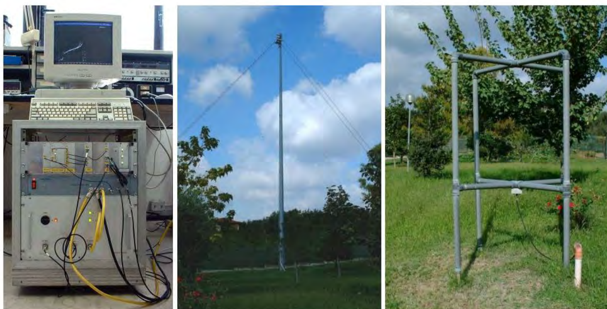
La ionosonda Advanced ionospheric Sounder AIS-INGV con la quale vengono effettuati i sondaggi ionosferici di routine degli osservatori di Roma, Gibilmanna, Tucuman e Bahia Blanca.
