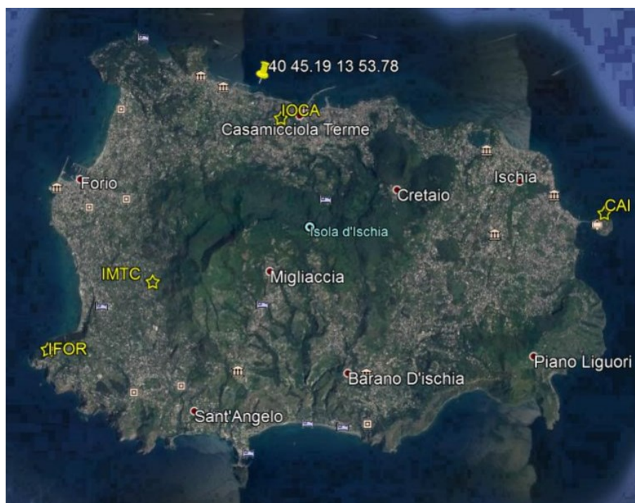
Figura 3 - Epicentro terremoto del 21 Agosto 2017 ore 18:57 UTC calcolato col programma NonLinLoc col modello di velocità 3D di D'Auria et al. (2008)
